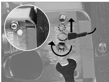
**Montage des Empfängermoduls** Auf diesen freiliegenden Gewindestift die Unterlegscheibe aufschieben, dann den Kabelschuh, welcher mit einem Draht mit der Empfängerbox verbunden ist, darauflegen. Anschließend die Mutter wieder aufschrauben und so festziehen, dass **der Kabelschuh nach hinten zeigt**. Wenn dieser Kabelschuh nach innen gedreht ist, verbrennt dieser beim Einführen des Brennerschiebers.
